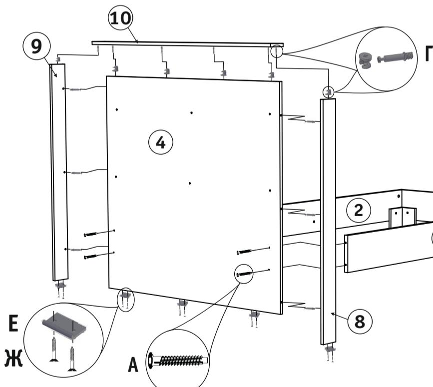
Рис. 3. Установка спинки.
