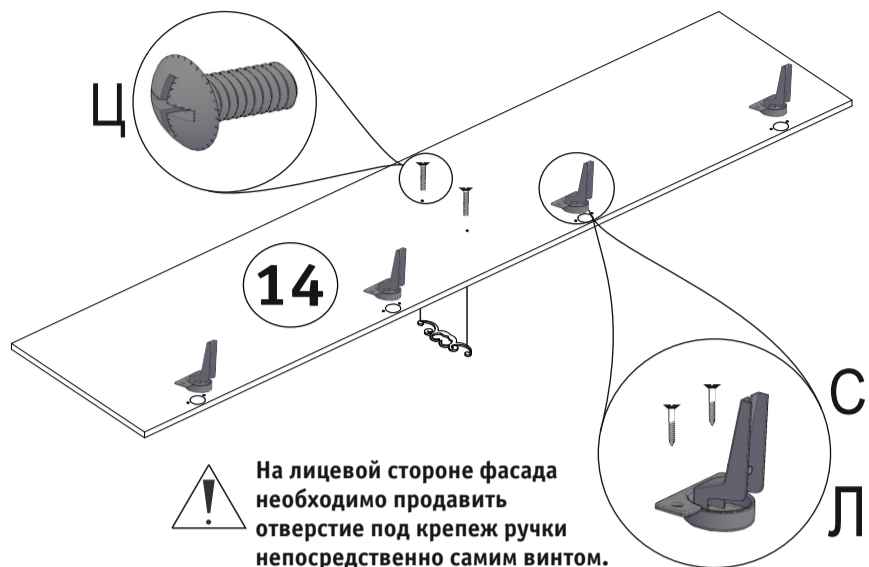
Рис. 5. Установка петель на фасаде.
