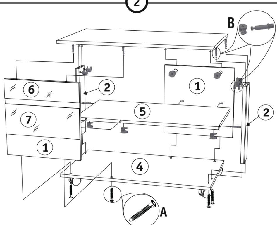
Рис. 2. Сборка каркаса.
