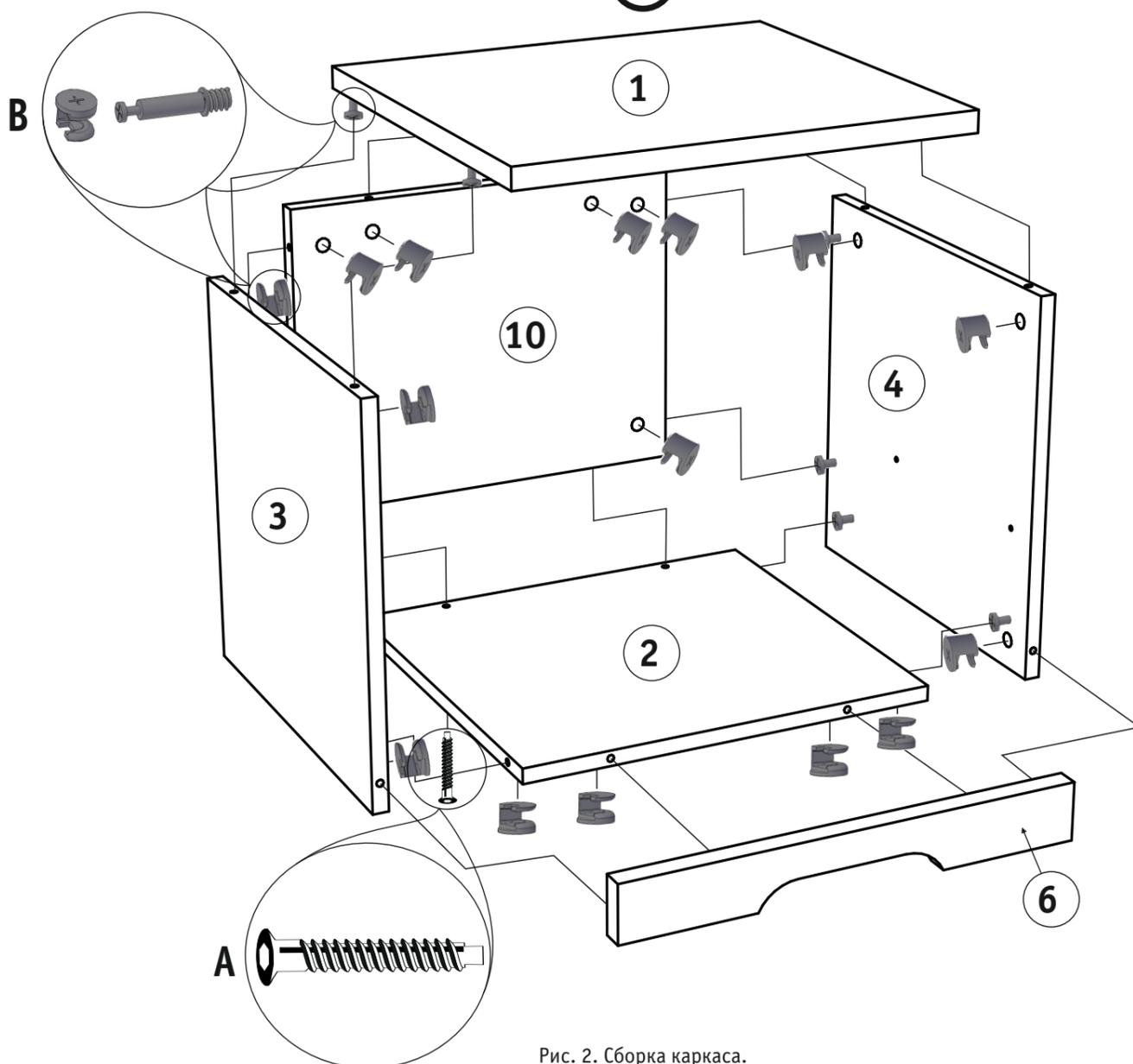
Рис. 2. Сборка каркаса.
