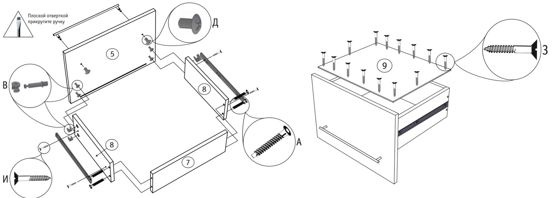
Рис. 1. Сборка ящика.
