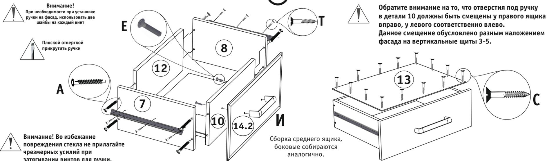
Рис. 1. Сборка ящика.
