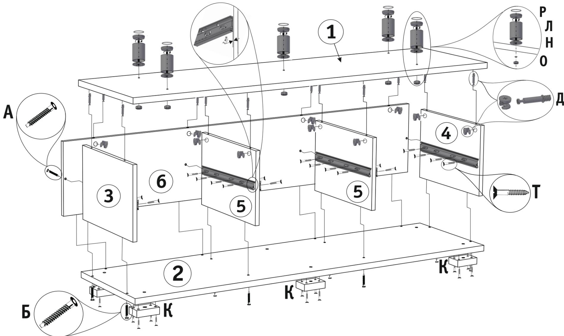
Рис. 2. Сборка каркаса.
