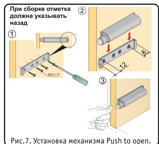
Рис.7. Установка механизма Push to open.
