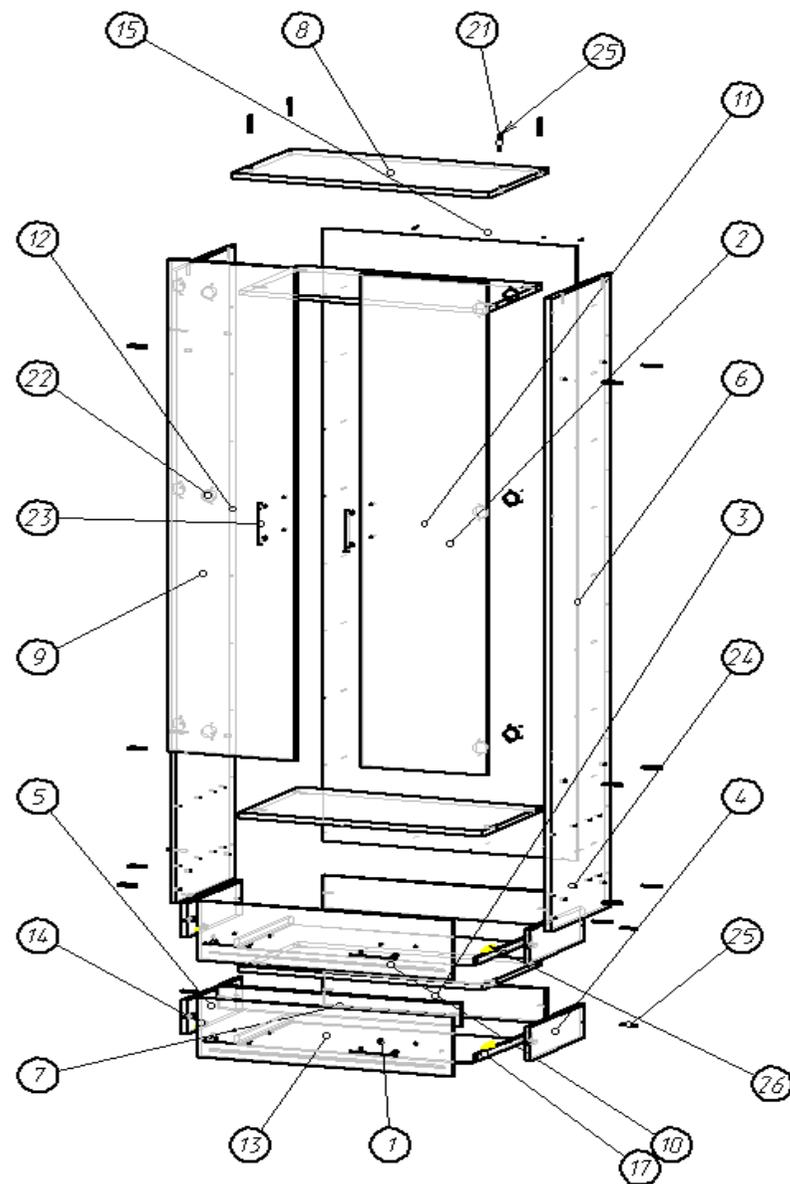
Рис.2. Сборка шкафа с ящиками МК-3.
