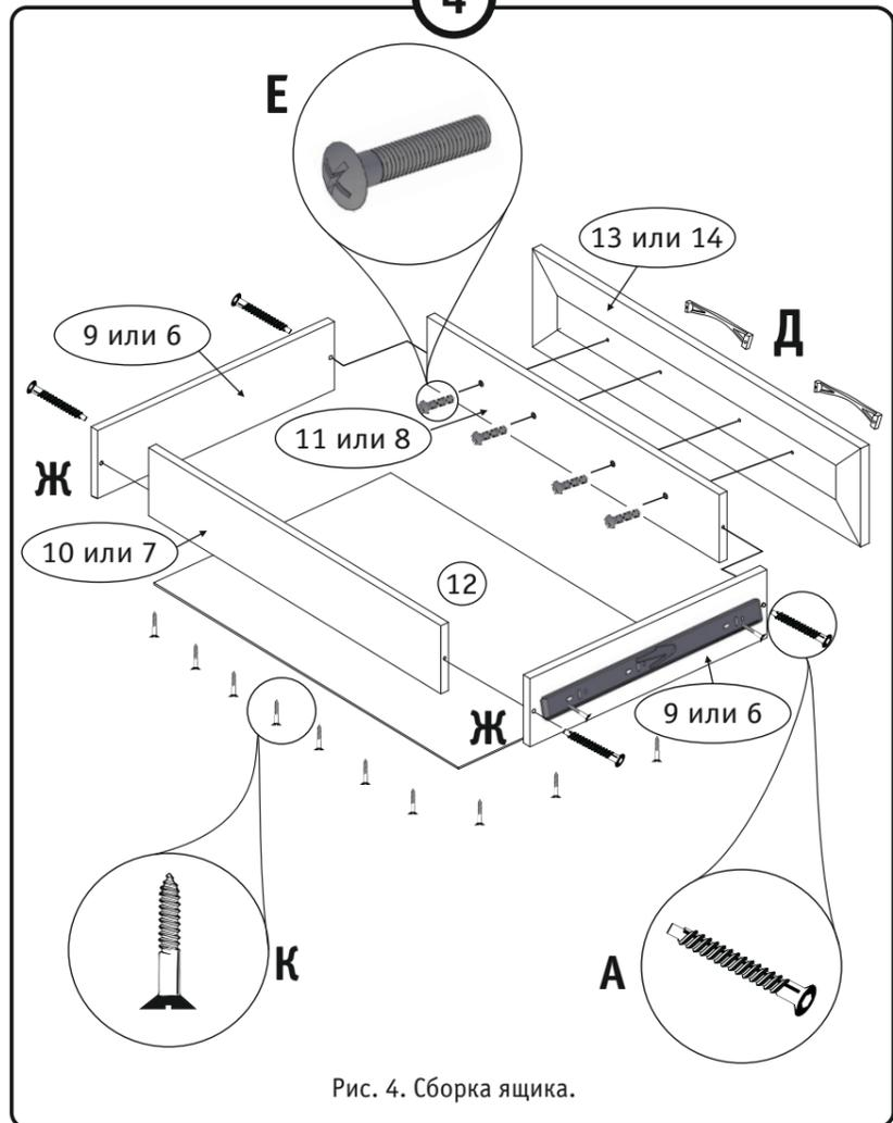
Рис. 4. Сборка ящика.
