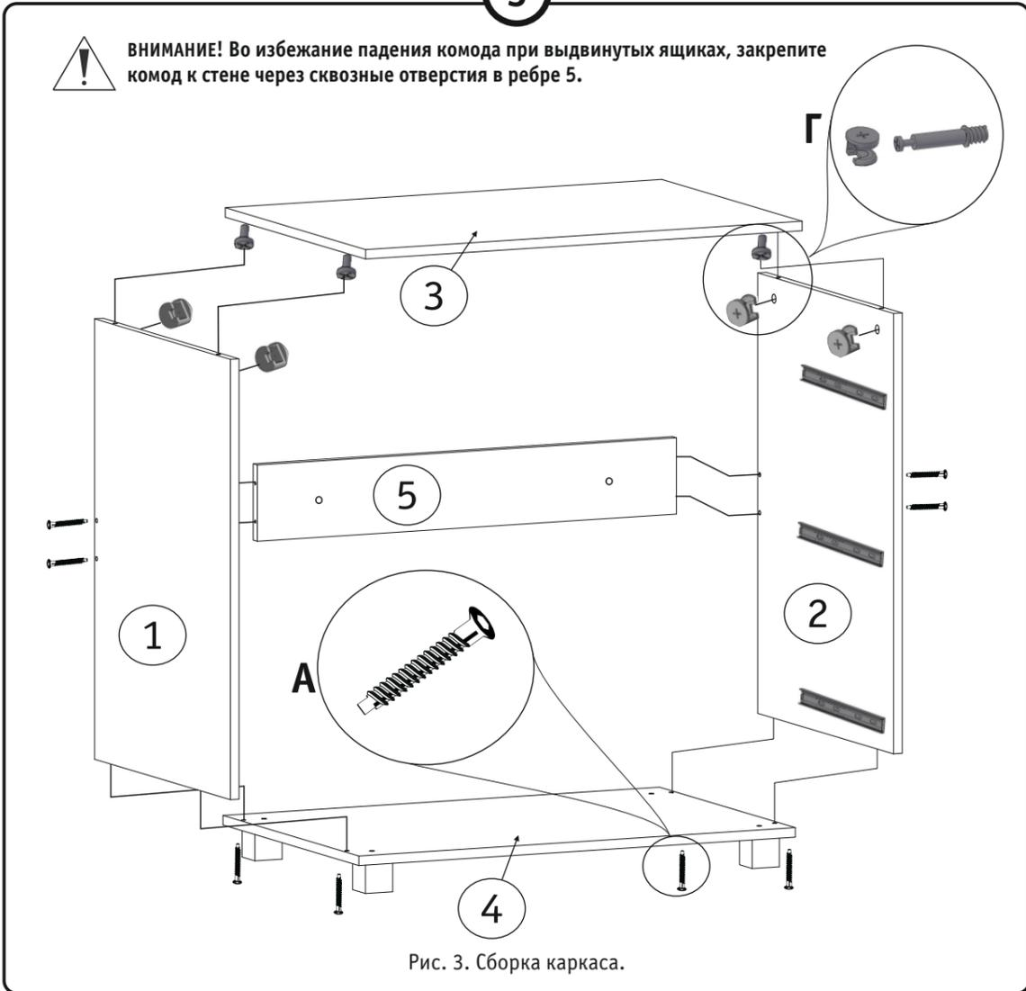
Рис. 3. Сборка каркаса.
