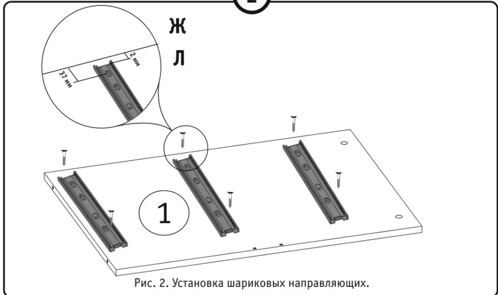
Рис. 2. Установка шариковых направляющих.
