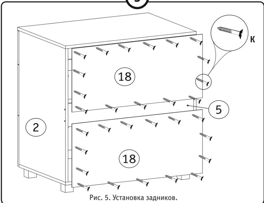
Рис. 5. Установка задников.
