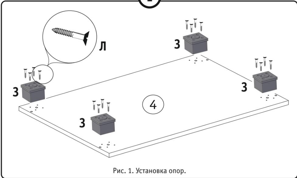
Рис. 1. Установка опор.
